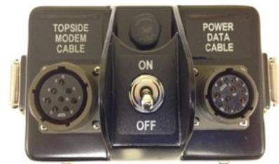
Figura 10: Conexiones de la unidad de batería de la parte superior
