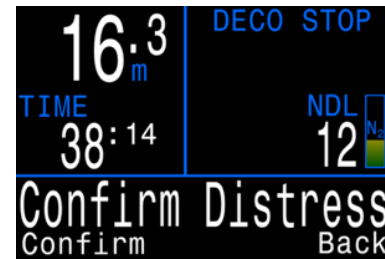
Figura 67 Confirmar pantalla de socorro
